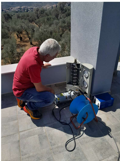
Εικόνα 3. Εγκατάσταση οργάνων συλλογής και μέτρησης της συγκέντρωσης των ατμοσφαιρικών σωματιδίων.
